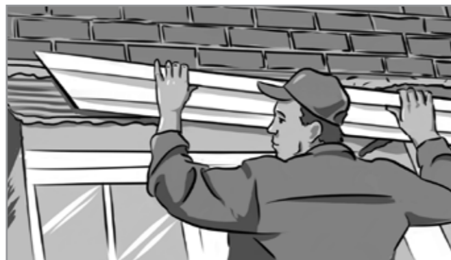
Рис. 7. Элемент с клеевой массой вручную прижимается к несущей поверхности.
