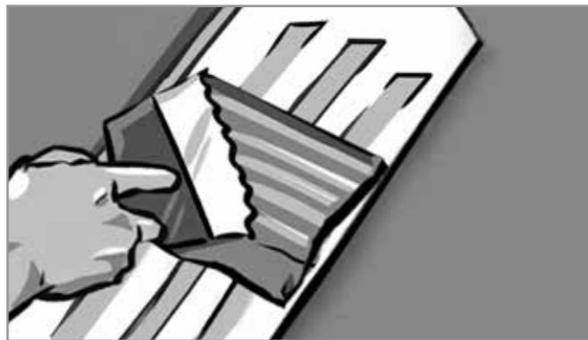
Рис. 6. Нанесение монтажного клея на элемент декора.
